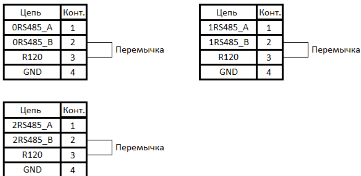
Рис 7.2.1. Подключение перемычек для терминирования портов RS485
