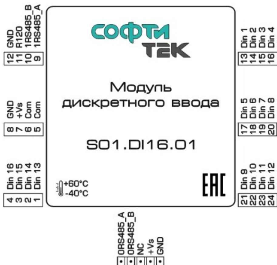
Рисунок 6.2 – Назначение клемм
