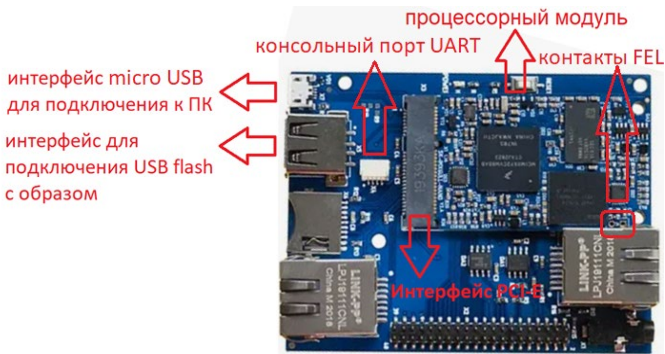
Рис. 5. Материнская плата SK-iMX6ULL-NANO-2E-MB с процессорным модулем SK-A40i-NANO-2E
