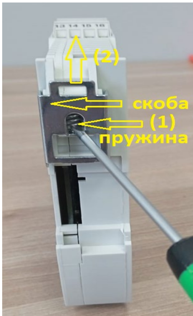
Рис. 1. Снятие пружины и скобы
